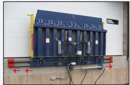
El conjunto de carro de rodillos permite el movimiento lateral para adaptarse a la posición del vagón.
